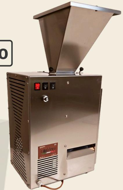
La macchina Frangidepellicolatrice **MI30** è una macchina realizzata in acciaio inossidabile. Il funzionamento è pratico e veloce: le fave di cacao vengono sbriciolate e depellicolate ottenendo, attraverso un sofisticato sistema di ventilazione e in **cassetti separati**, la granella e un prodotto di scarto derivato dalla frantumazione delle bucce.
